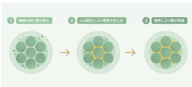
ピエクレックスの原料である植物由来のポリ乳酸は、応力を加えると圧電効果により電気を発生します。ピエクレックスは、このポリ乳酸が持つ圧電性を活用し、繊維が動く際に「圧電効果」が生じることで電気を生み出します。
